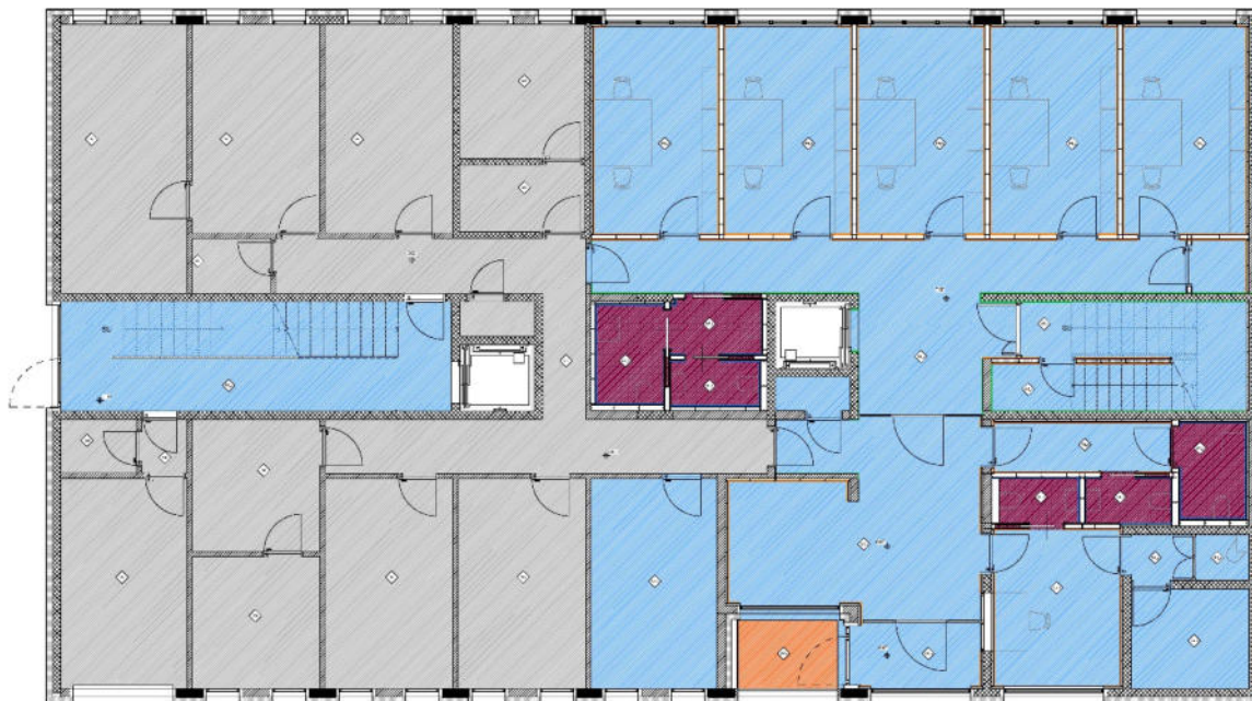
Fig. 19 – Pianta delle pavimentazioni e finiture al piano terra – in azzurro le superfici a gres di dimensioni 60x60 cm, in viola gli ambiti con gres 20x20 cm, in grigio le superfici in calcestruzzo a spolvero
